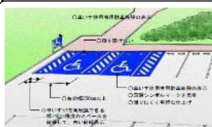
車椅子使用者用駐車場を確保
