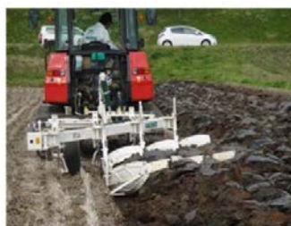
左：表土の削り取り作業 右：表層土と下層土の反転 又は深耕
