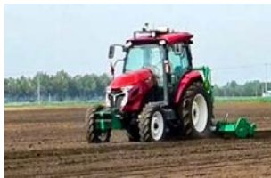
準天頂衛星を活用した自動走行トラクター
