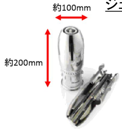
ジェットエンジンの燃料噴射装置は、内部構造の複雑さからこれまで6部品を別に製造し、これらを組み合わせて製造していたが、現在は内部構造も含めて複雑な形状を一気に造形することができる付加製造技術を活かし、一体造形を行っている。一体化により、工期の短縮(1/3程度)が実現しているだけでなく、これまでロウ付けしていたノズルを一体化することで、強度の向上にもつながっている。
