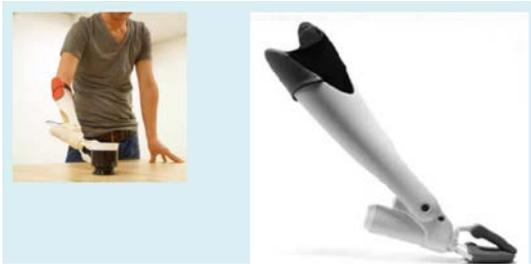
容易に装着、操作可能な電動義手の開発において、3Dプリンティングを用いることで、短サイクルの施策と検証を重ね、アイデアの誘発と最適化を実現した。
