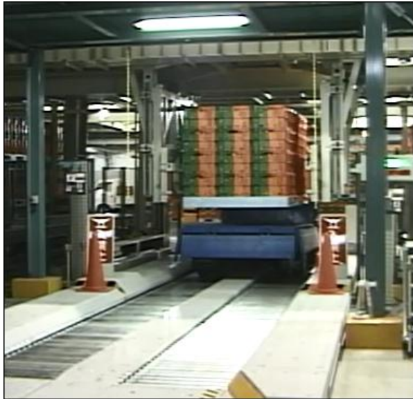
みかん選果場 パレットを トラックから自動降ろしロボット
