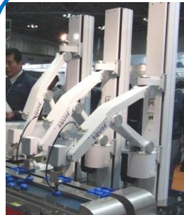
食品を詰替えるなど、繰り返しの単純作業を自動で行うロボット
