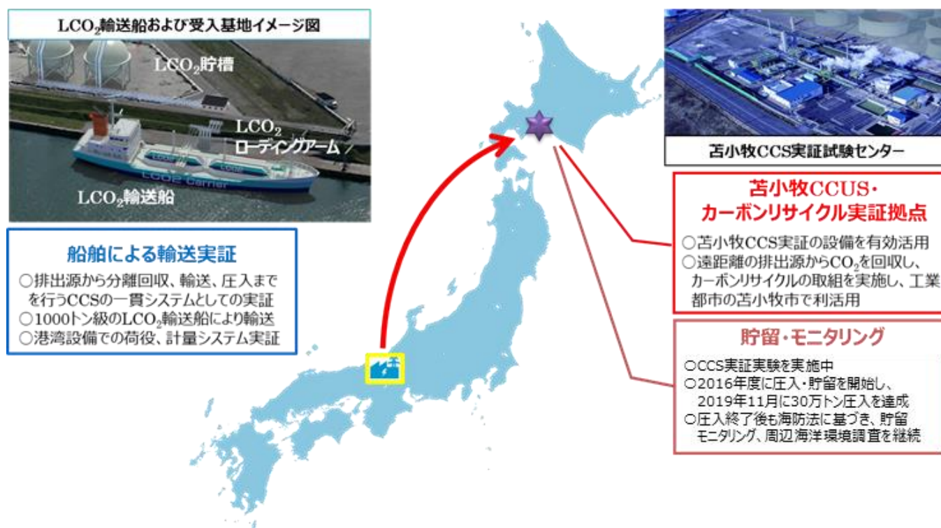
図 10 排出源と再利用・貯留の集積地とのネットワーク最適化と液化二酸化炭素船舶輸送（ハブ&クラスター） <出典> 経済産業省
