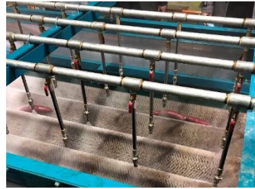
かんしょの洗浄機械 洗浄ブラシの素材の違いで、 かんしょの傷のつき具合を検証
