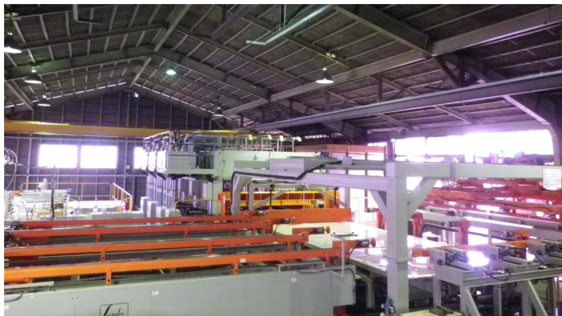
写真 CLT製造ライン(銘建工業(株)内)
