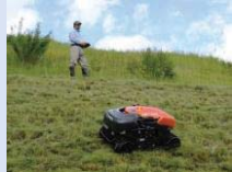
無線草刈機の運用に対応した傾斜
