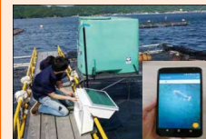
自動給餌機 (スマホで確認しながら遠隔給餌)
