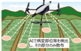
ピンポイント散布 AIで病変部位等を検出し、その部分のみ散布
