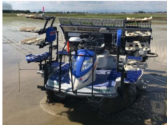
自動運転田植機 (農研機構実証ほ場 (埼玉県) )
