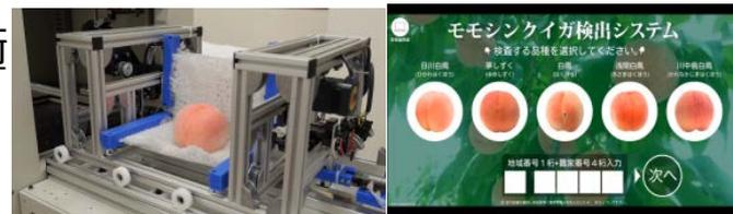
X線、光切断法等検査による全数検査
