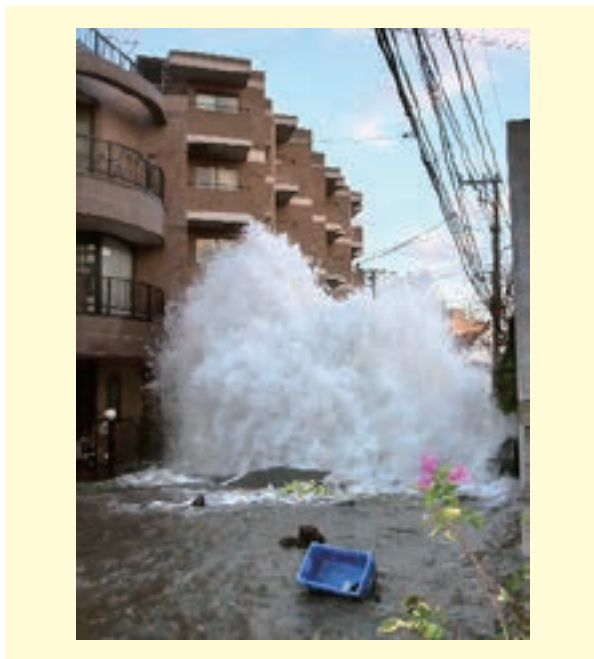
写真1-5 老朽化に起因する水道管の破損による水の噴出事故
