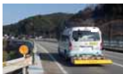
電磁波レーダー搭載車による床版上面を調査
