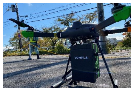
最大積載重量：4kg 機体重量：7kg 機体サイズ：930mmx930mmx 680mm 使用機体数：1機 耐風性能：8m/s以下
