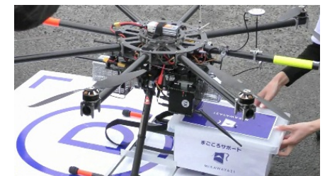
⑥輸送容器の取り外し
