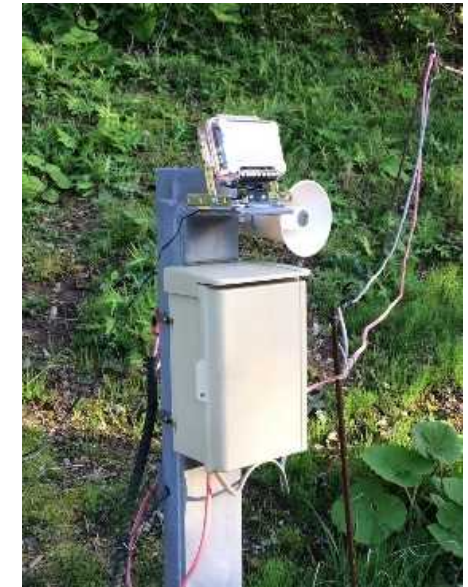
カメラで受取所の状態を常時監視、ドローン着陸時に人がいる場合は、スピーカーで注意喚起を行い移動を促す。
