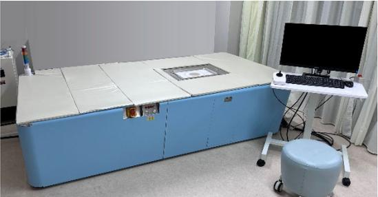
(図2) 光超音波イメージング装置の試作機
