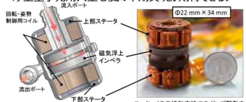
■ 世界初の磁気浮上型小児用人工心臓の概要 ■ インペラ非接触支持でのポンプ駆動を実現可能とする超小型磁気浮上モータ
