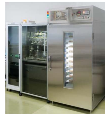
閉鎖型大面積自動培養装置 最大培養面積: 5,000cm 2
