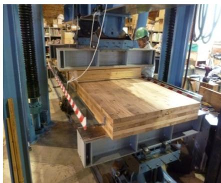
試作したCLT(スギ)の強度試験の様子(平成24年度)
