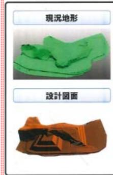
3次元測量データ（現況地形）と設計図面との差分から、施工量（切り土、盛り土量）を自動算出。
