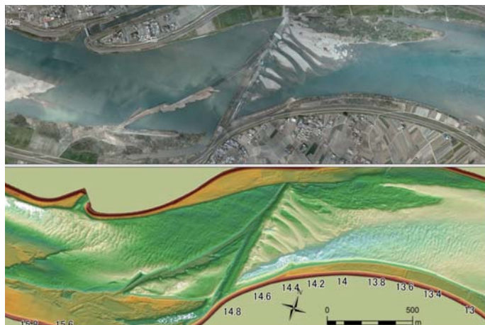
有人航空機搭載型グリーンレーザーによる水中地形 株式会社バスコ
