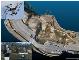
ドローン等による写真測量等により、人の立ち入れない危険な急傾斜も短時間で面的（高密度）な3次元測量を実施。
