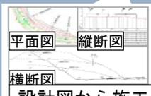
設計図から施工土量を算出
