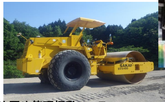
[締め固め管理振動ローラー :盛土締め固めの面的な品質管理]
