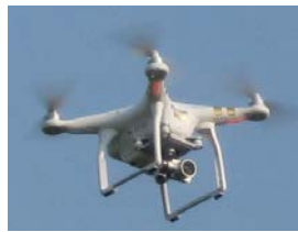
UAV(ドローン等)による3次元測量
