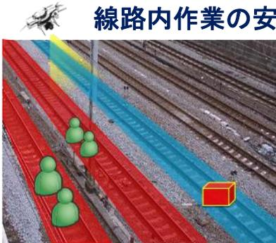
(例) 上空のドローンから、作業開始時、終了時に線路上に支障物がないか等の安全確認を行う。
