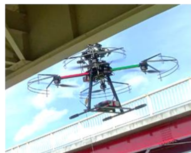
▲橋梁の損傷写真を撮影する技術
