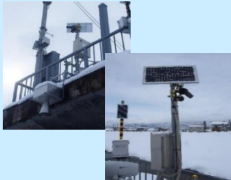
寒冷地対応危機管理型水位計の例
