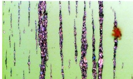
健全な潤滑状態で発生した小さな摩耗粒子（5 $\mu\text{m}$ 以下）
