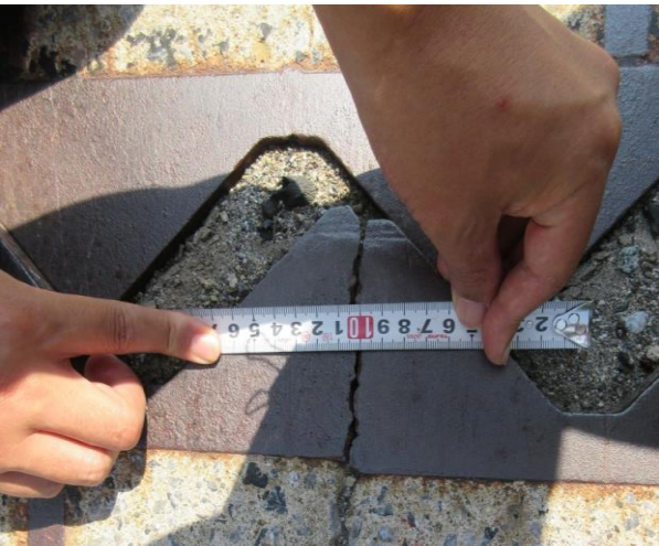
取替え後2年で、破断
