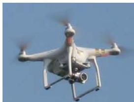
UAV(ドローン等)による3次元測量
