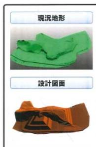
3次元測量点群データ(現況地形)と設計図面との差分から、施工量(切り土、盛り土量)を自動算出。
