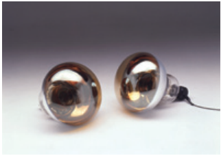
内水槽に取り付けられている20インチ径光電子増倍管 (写真: 浜松ホトニクス(株) 提供)
