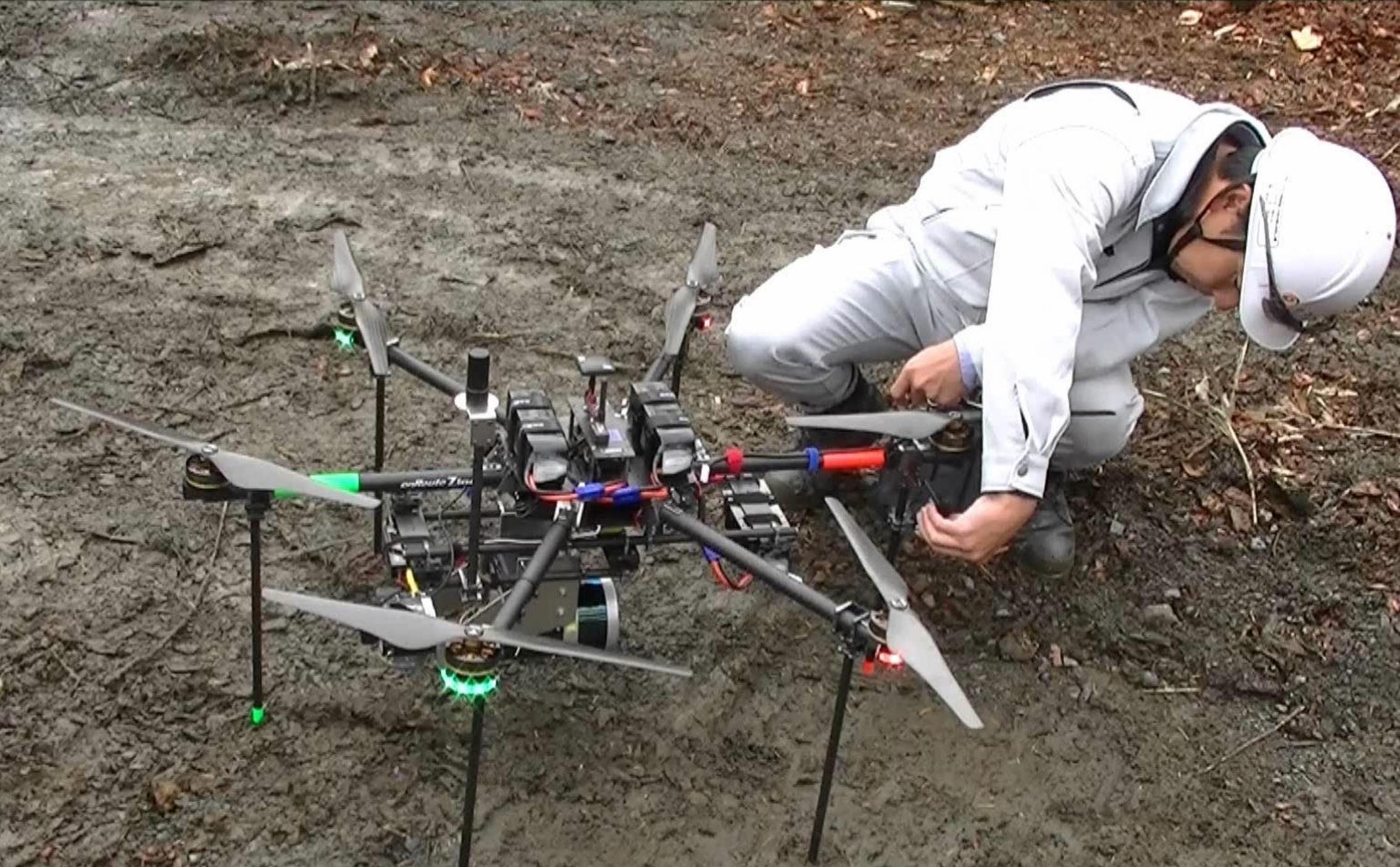
機動性の高いドローンにレーザスキャナーを搭載
