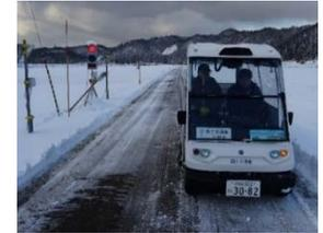
自動運転車両の専用の走行空間の確保（簡易信号の設置）
