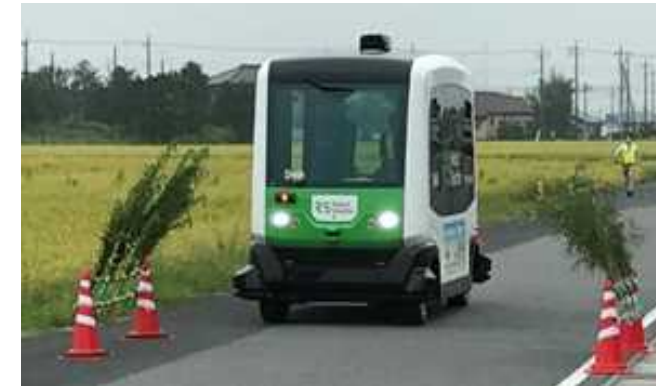
路面の落下物や障害物を再現し、自動運転に必要なとなる道路の管理水準を検証
