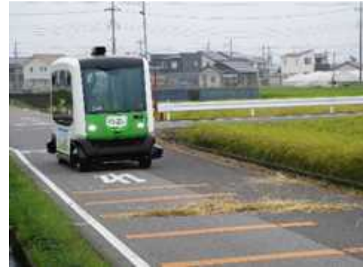
路面の落下物や障害物を再現し、自動運転に必要なとなる道路の管理水準を検証
