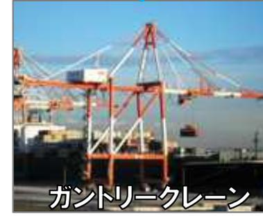
船舶へのコンテナの積卸しを行うための荷役機械。
