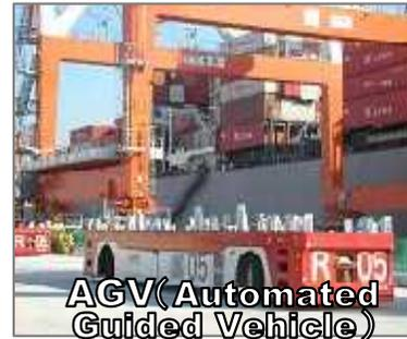
岸壁-コンテナヤード間の搬送を担う、無人のコンテナ搬送用台車。
