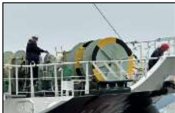
（係船・投錨時のウインチ作業の遠隔自動化）
