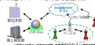
<IoTを活用した航路標識監視体制の構築>
