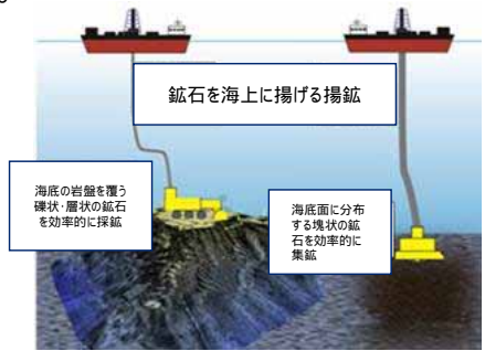
海洋鉱物資源の採鉱・揚鉱イメージ図
