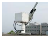
エアロゾル観測の強化 エアロゾルの量だけでなく、性質(黄砂、煤煙等)も観測可能な観測装置を整備
