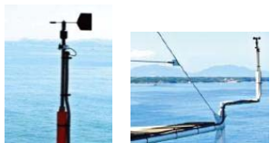
風況調査 (左:風向計、右:風速計)
