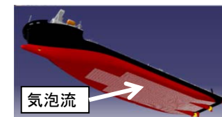
気泡を用いた船体抵抗低減
