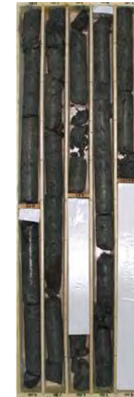
BMSで採取した 海底熱水鉱床鉱石
