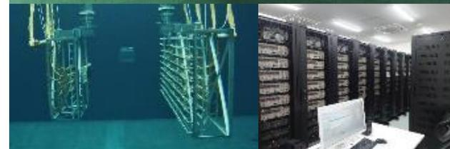
シミュレーションで模擬する音を大型水槽内の音響アレイで再現
