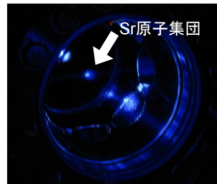
超高真空装置内でレーザー冷却された極低温Sr原子集団
