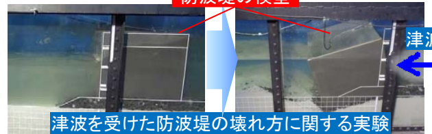
世界最大規模の人工津波実験施設による実験
