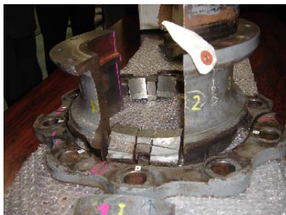
破損したホイールハブ (新交通システム)
