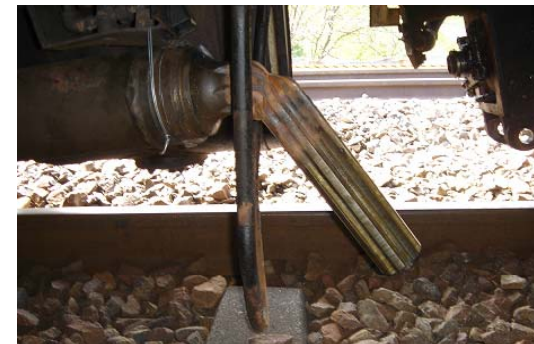
車両の推進軸脱落事故対策調査 (石勝線列車脱線事故)
