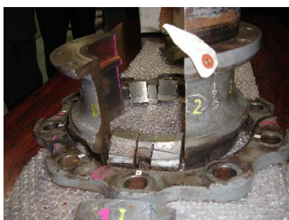
破損したホイールハブ (新交通システム)
